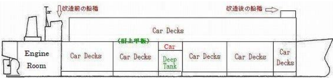
上が「第七全購連丸」下が改造後の「富士丸」の側面略図。 各ホールド内と旧上甲板上
