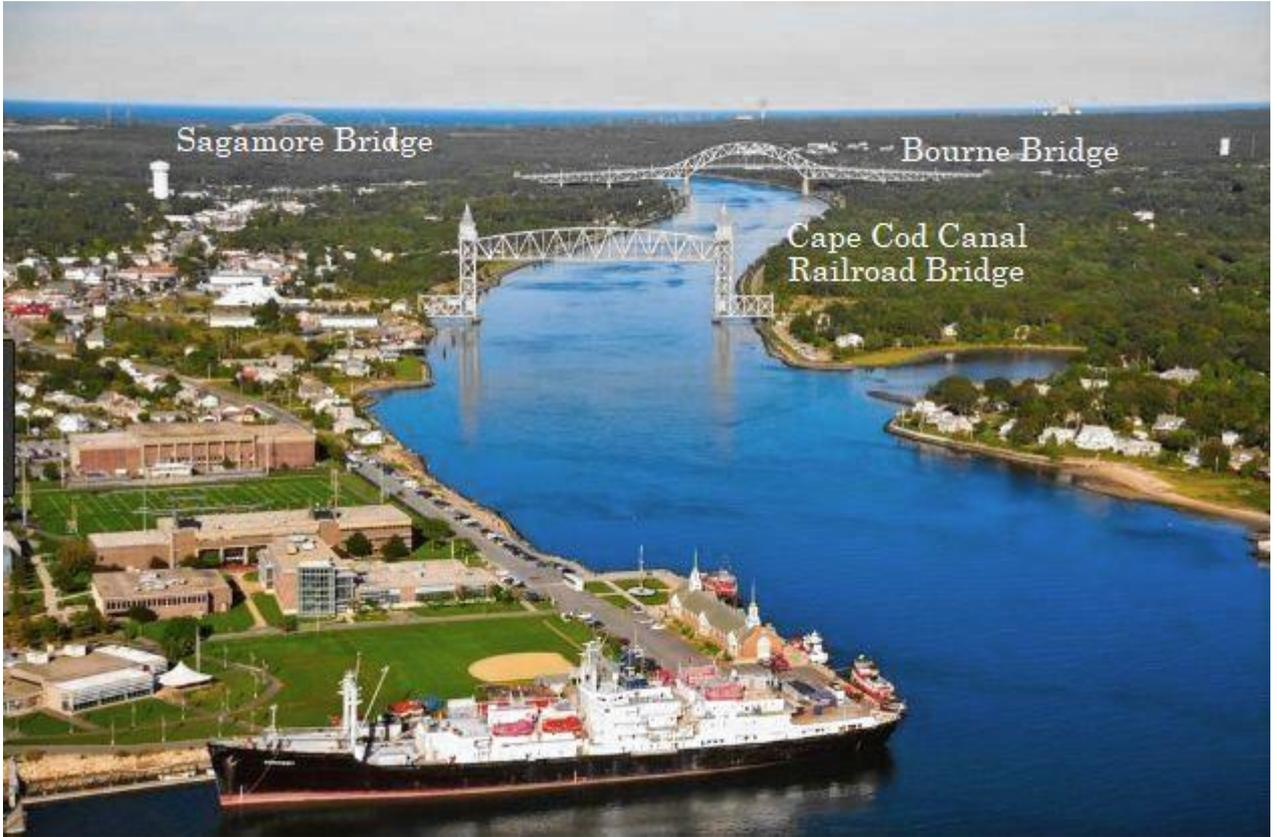
この運河には三本の橋が架かっています。手前から C.C.運河鉄道橋、ボーン橋、サガモア橋で、夫々の橋の下面の最小クリアランスは 135 ft (41.1m) に揃えてあります。
