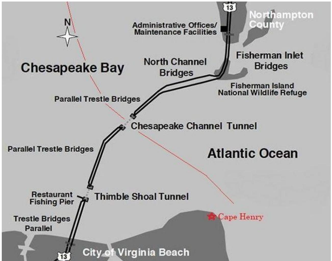
上図の二重線は橋、二か所で二重線が途切れて点線に代わっていますが、ここがトンネル部分です。トンネルの両側にある小さな四角の場所に人工島を造ってあるのです。
