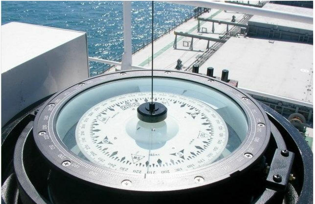
これはブリッジ bridge=船橋の両ウィング wing=翼部には必ず付いているコンパスです。当時、主として使っていたのはジャイロ・コンパス gyro compass という物です。盤面の真ん中に立っている黒い針状の物はシャドウ・ピン shadow pin と言いますが、片目をつぶってこの針と目標を合わせそのまま目線を落として針が合っている度数を読み取ります。全く簡単至極、単純明快。
