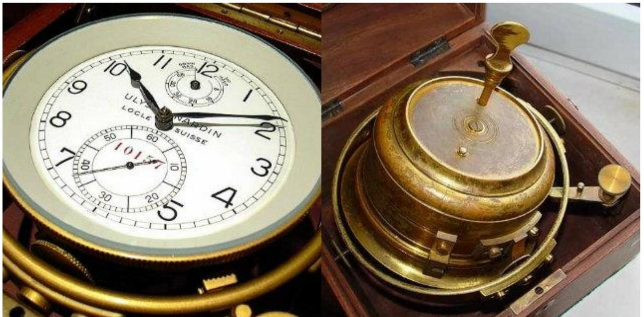
クロノメーターは要するに正確な時計であって、GPSや正確なデジタル時計がある現在なら全く無用の長物でしょうが、六分儀で星の高度を測って位置を計算していたその頃では天測には欠かせない重要な器具でした。
