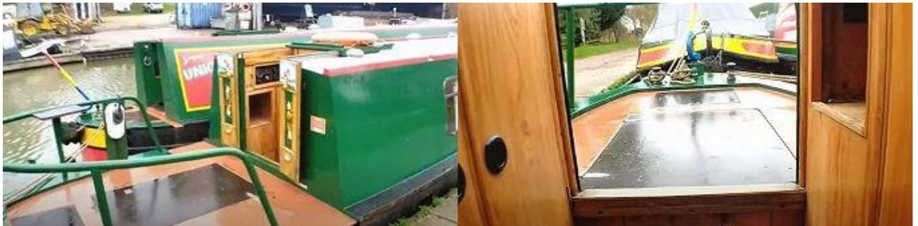
左は船尾デッキの形、ナロウボートにはいろいろなタイプの船尾構造がありますが、このタイプをCruiser sternと呼びます。最後部にはTiller 舵柄＝梶棒があり、左舷のハンドレール手摺りにはエンジン・コントロール・レバーがあります。要するにここは大型船ならブリッジ＝船橋と呼ばれる所。スキッパー＝艇長＝船長殿の居場所です。
