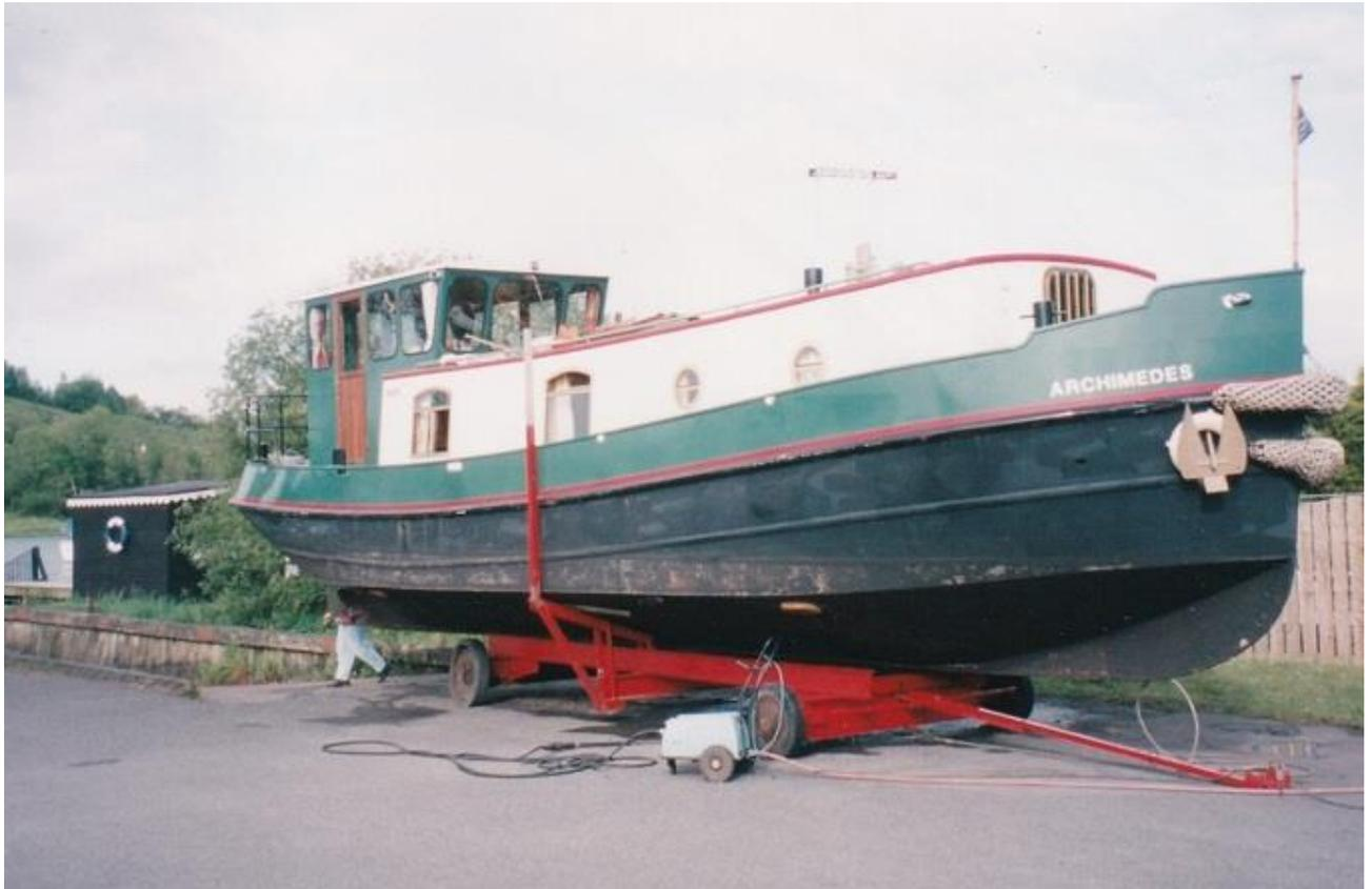
これがそのボート Archimedes、船尾に足だけ見えているのがオーナーのジー様。チョット短いね。　その左手すぐ向こうに見えている溝のようなものが slipway と呼ばれるもので、水上に浮かぶ船を陸上に引っ張り上げるために造られたスロープです。この訳語は船架とか斜路となりますが、要するに陸の平地から水中にかけて造られたスロープです。　マズ、そのスロープに台車を下ろし水中迄沈めます。　次にボートをスロープのある陸岸と直角に進入させて台車の真上に止め、ボートと台車を固定します。これで準備 OK。　それから台車をスロープの延長線上に据えた引き揚げ機械で、又は大型フォークリフト等の重量車両を使って引き揚げます。
