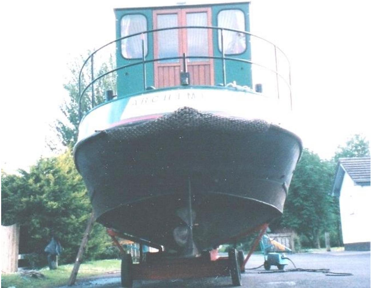
このように至ってシンプル。 スクリュー一基、舵板も一枚、これを single propeller ・ single rudder と呼び、船の基本的な設備構造です。
