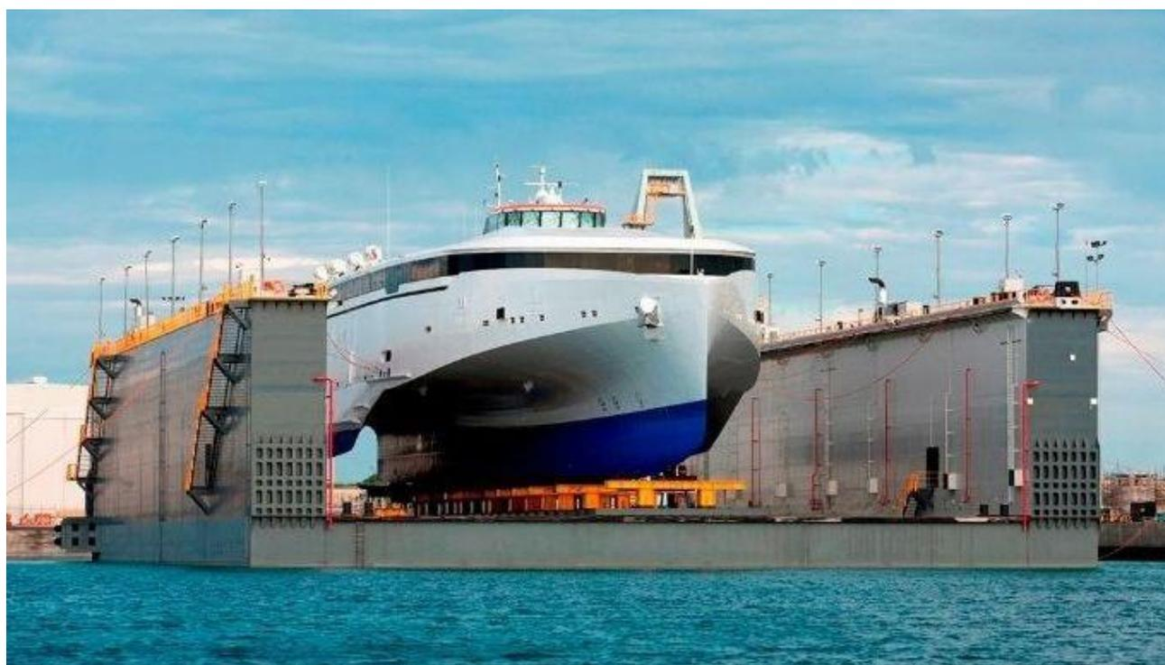
白い船体の船が乗っかっているグレーの四角張った構造物、これが floating dock です。そして、このグレーの鋼板の内部は最上部の機械室部分を除いて大部分がバラスト・タンクになっています。この構造物の機能を順を追って言うと次の通りです。
