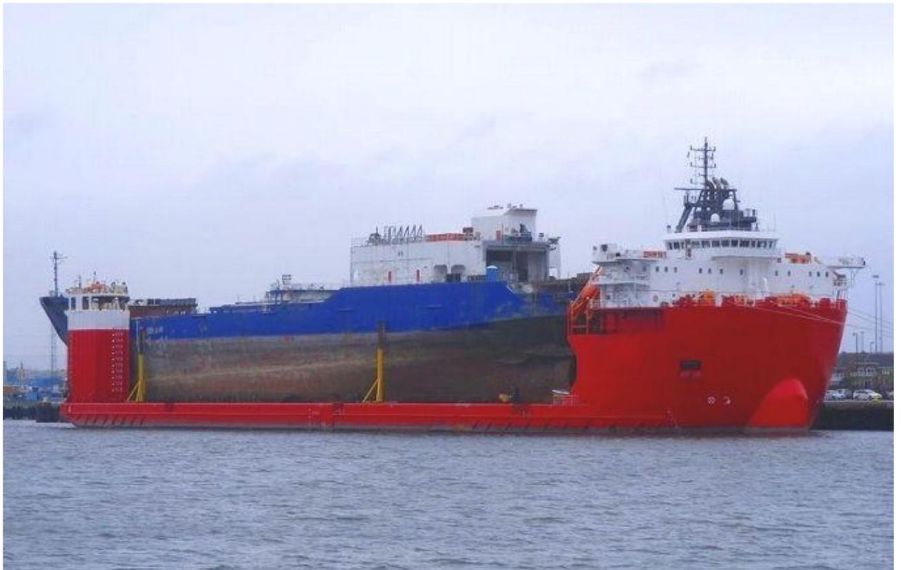
青い船体の船が、赤い船体のセミ・サブマージブル・ヴェセルに乗っかっています。こうなる迄の手順は、まず赤い船のバラスト・タンクに充分注水して、青い船が乗っかっている中央部分の赤い台形のプラットフォーム上面が青い船体の吃水より深くなるまで赤の船体を沈めます。この時点で赤塗部分は殆どが水面下に沈むことになるでしょう。そうしておいて青い船体を赤のプラットフォーム上に引き入れます。その後赤い船のバラストを排水して浮上させればこの画像の様になるわけです。ここにはキール・ブロックはなく、青の船体の船底は板敷の赤のプラットフォームに直に座ってます。これは何らかの理由で航行できなくなった青い船を、そのままの状態に運搬しようとしているのでしょう。別の手段としては大型の曳き船何隻かで引っ張って移動させるというテもありますが、大型船の外洋曳航はそれなりの危険が伴うし、時間もかかります。
