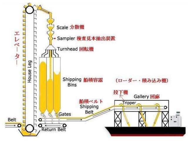
Scale 分散機とは、サイロに貯蔵されている間に穀類が固まってしまったのをバラバラの 粒に戻す機械だと思います。 船にとって肝心なのは船内に穀類をばら撒く投下機。 この航海で第19とよた丸が小麦を積んだのはこんな所でした。
