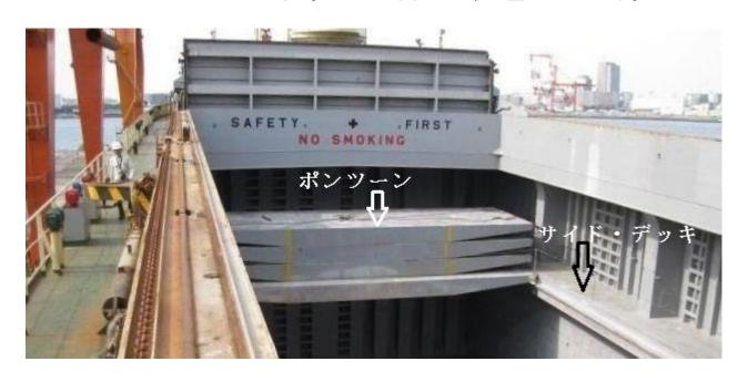
ポンツーンの右側はサイド・デッキ。 この船では固定デッキですが、第19とよた丸の場合はもっと幅が広く、ワイヤーで吊り上げが出来る可動デッキでした。 また、ポンツーン・ラック pontoon rack とは次のようなもの。
