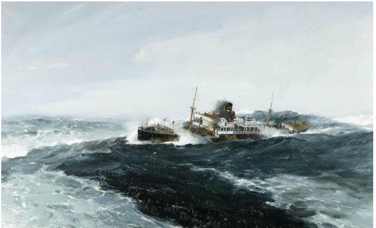
復元力が大きすぎる、即ち動揺周期が短い状態でこういう海面状況では何があっても可笑しくない。なぜなら、復元力が大きすぎると、片方の舷から、例えば左舷から、波を受けて右舷に傾くと、復元力が大きいが故に、その揺り返しで今度は左舷にまで傾いてしまう。言い換えれば波が押し寄せてくる方向へまで傾いてしまうのです。
