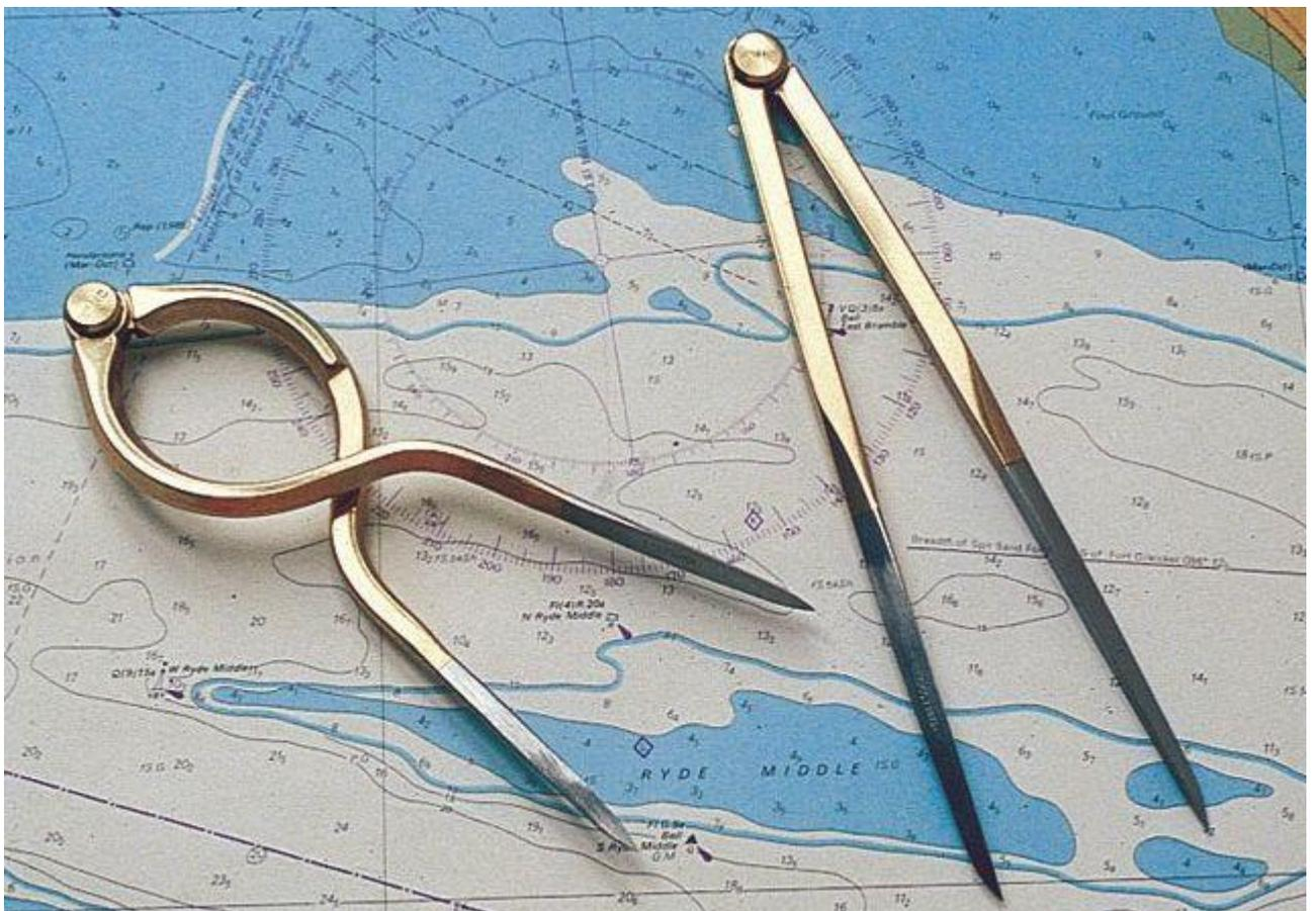
まず、定規の上で船の速力分だけデバイダーの両ポインターを開いて合わせて置き、先程の手順で最初に盤に印をつける点にデバイダーのポインターの片方を当て、もう片方のポインターを真後ろに下がった点に当てます。二つ目のポインターまで定規をずらして、その時定規が指した外枠の目盛りが真風向、ポインターが当たっている
