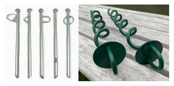
左は mooring pin と呼ばれるシンプルなもの、これはハンマーを使って土手に打ち込み 頭部のリングに係留索を通して使います。 弱点は打ち込んだ地面から抜けやすい事。 一方右側は地面に捻じ込んで頭部のリングにロープを通します、捻じ込む作業は打ち込み より手間がかかりますが、この方が抜けにくいことは確かです。 これは spiral pin とか screw pin とかいろいろ呼び方があるようで、形も次のように色々あります。
